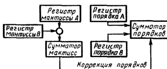
Рис. 5.3. Структурная схема множительного устройства с плавающей запятой
